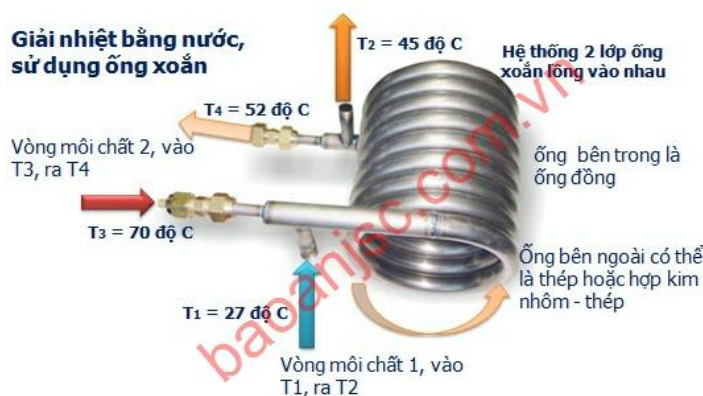
Hình 0.6. Nguyên lý hoạt động của bộ sinh hàn bằng nước sử dụng dạng ống xoắn
