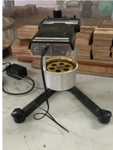
Hình 17. Máy đo độ nhớt mã hiệu VISCOTESTER-345030 phòng thí nghiệm
