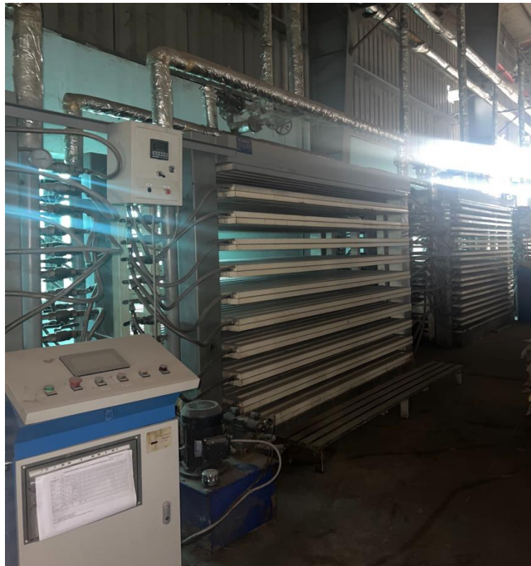
Hình 84. Máy sấy kẹp ván mỏng bằng hệ thống nhiệt dầu - Nhà máy Hưng Thịnh BG
