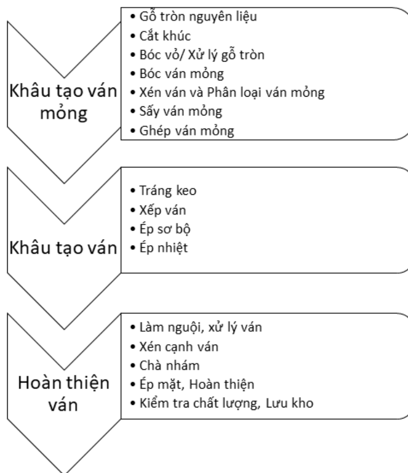
Hình 91. Sơ đồ quy trình sản xuất ván gỗ dán E1 và CARB-P2/E0/F*** xuất khẩu
