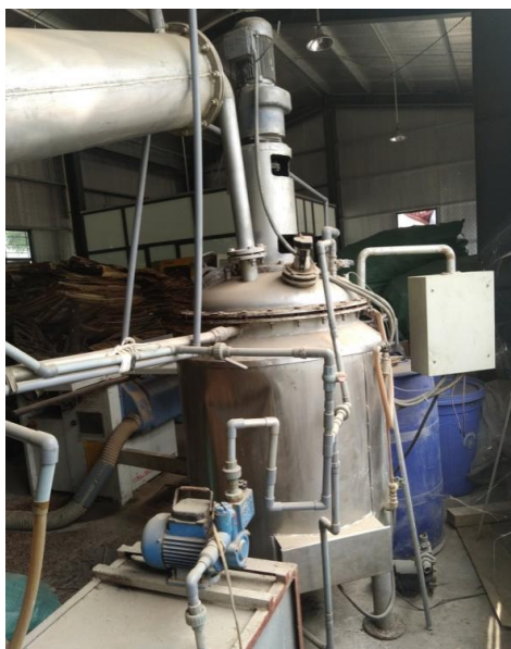
Hình 0.3. Thiết bị sản xuất keo gia nhiệt bằng điện
