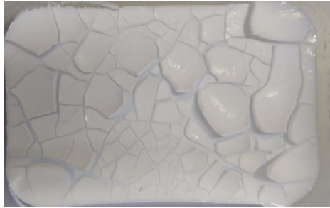
Hình 0.4. Hiện tượng keo bị đóng rắn, phân tầng không đảm bảo chất lượng
