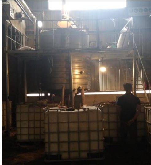
Hình 0.2. Thiết bị sản xuất keo gia nhiệt trực tiếp
