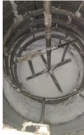
Hình 0.2. Thiết bị sản xuất keo gia nhiệt trực tiếp
