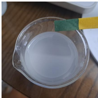
Hình 18. Xác định độ pH của keo dán bằng máy đo và giấy đo pH
