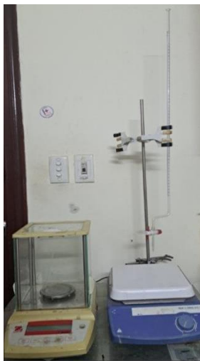
Hình 19. Xác định độ pH của keo dán bằng máy đo và giấy đo pH
